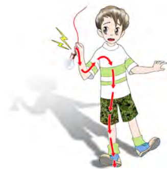
(b) 人触到了破损电器中的火线，电流流过人体入地，很危险
