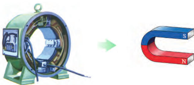
图 17-5 电动机定子简化过程的示意图
