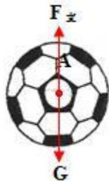
【总结升华】画力的示意图注意力的大小和方向，本题中重力和支持力是一对平衡力，因此线段的长短要注意；当一个物体上画多个力的示意图时，为了美观，把作用点都统一画在物体的重心上。
